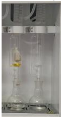
Gambar 4. Proses ekstraksi sokletasi
