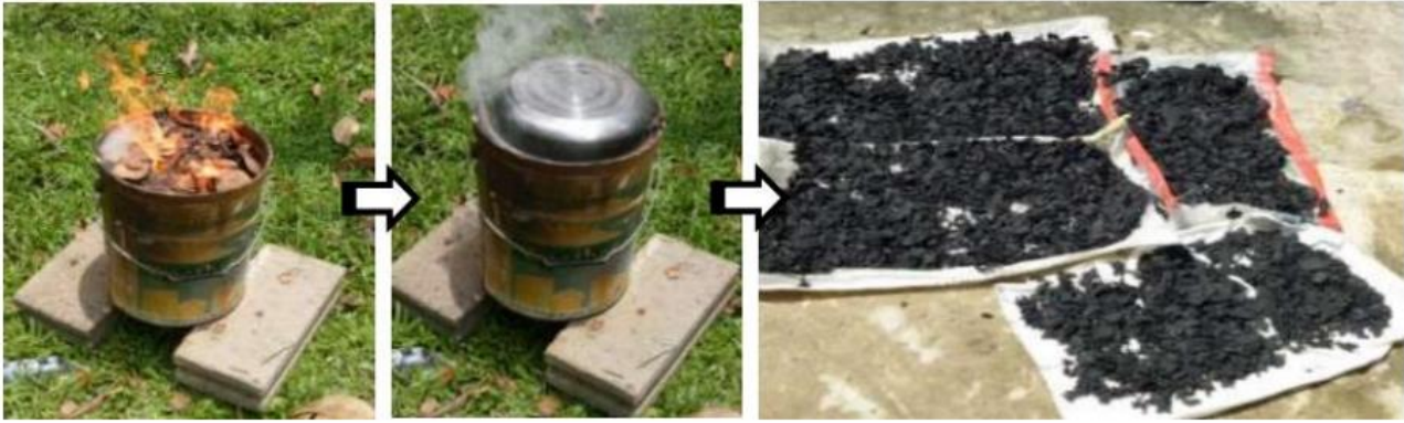
Gambar 2. Proses Pembuatan Arang dari Tempurung/Batok Kelapa
