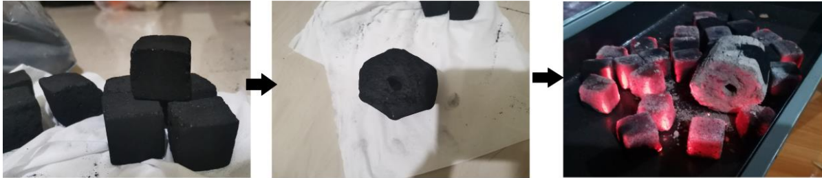
Gambar 3. Proses Pengujian Laju Pembakaran
