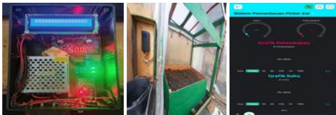
Gambar 8 Hasil perancangan perangkat keras, greenhouse dan Blynk IoT
