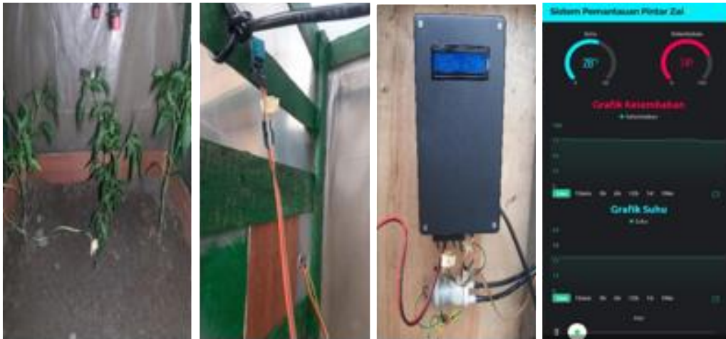
Gambar 9 Tata letak sensor, mini pompa dan aplikasi Blynk IoT
