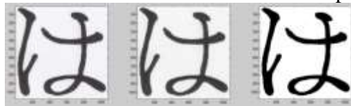
Gambar 3. Perubahan dari gambar RGB ke Grayscale, lalu ke black and white
